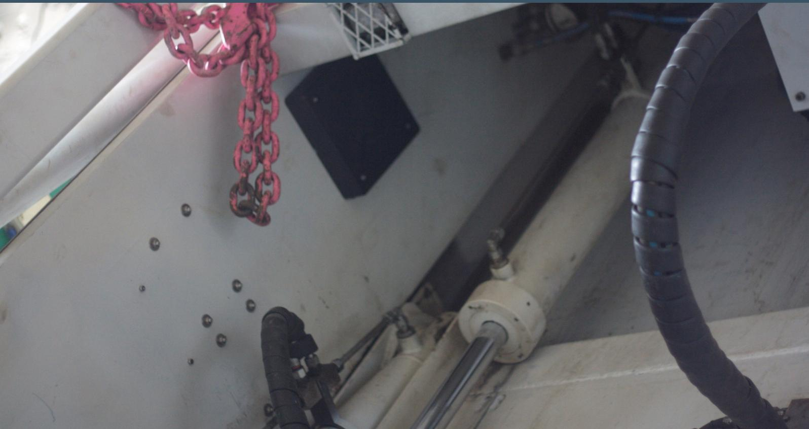
RFID-оборудование на мусоровозе находится всегда в опасной зоне. Всегда есть риск его повреждения падающими предметами. Мы подошли особенно ответственно к конструкции антенны. Ударопрочный корпус и степень защиты IP 68 позволяют нам обеспечить максимальную долговечность работы. Монтаж производится на стандартные конструкции мусоровоза.
