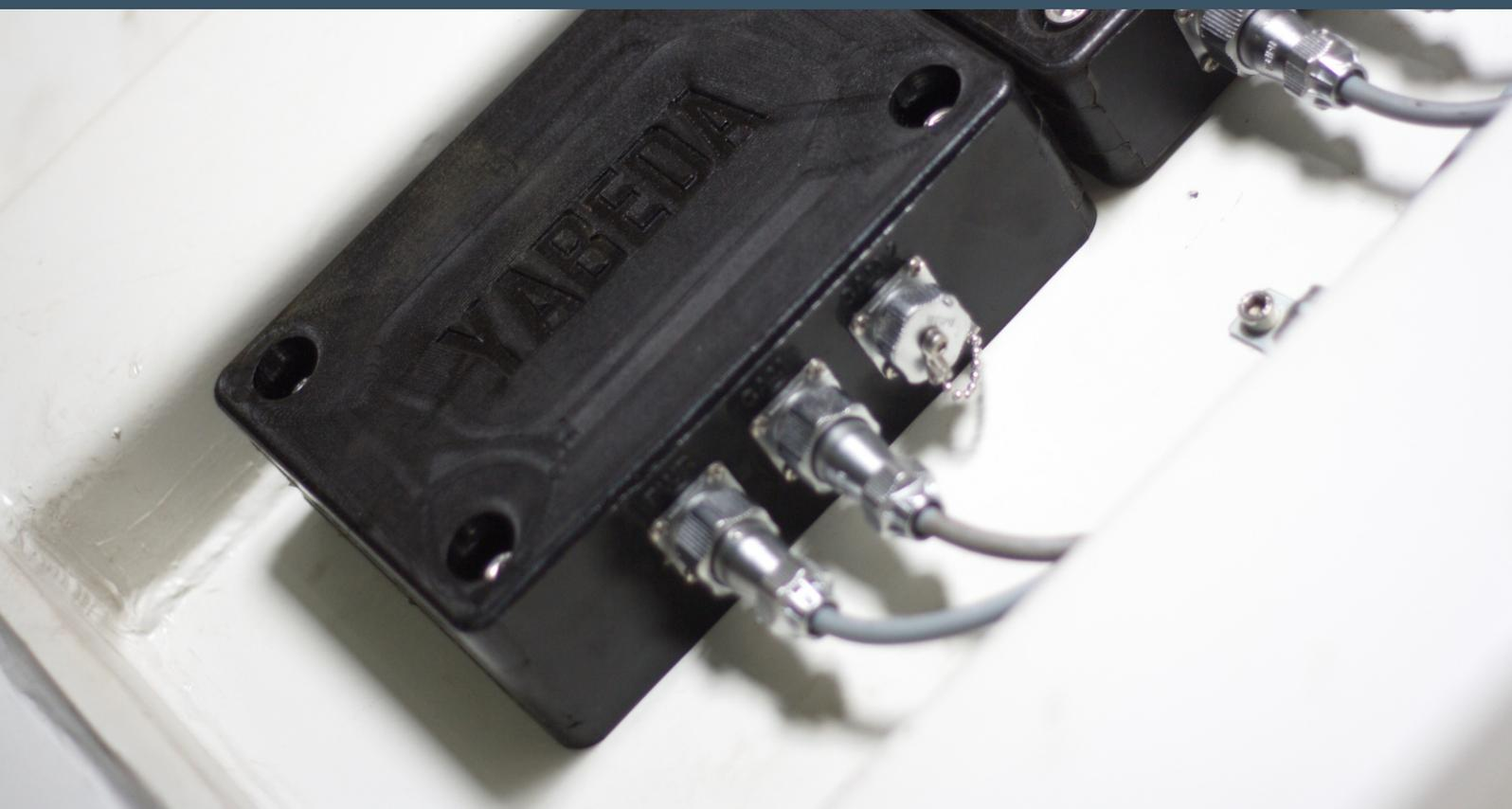
Всё наше оборудование полностью защищено от ударов, влаги и пыли, это обеспечивает максимальную надёжность и отказоустойчивость. Оснащение металлическими антивибрационными разъёмами позволяет гарантировать герметичность соединений и их надёжную фиксацию. В оборудование встроена защита от скачков напряжения и помех в электросети автомобиля.
