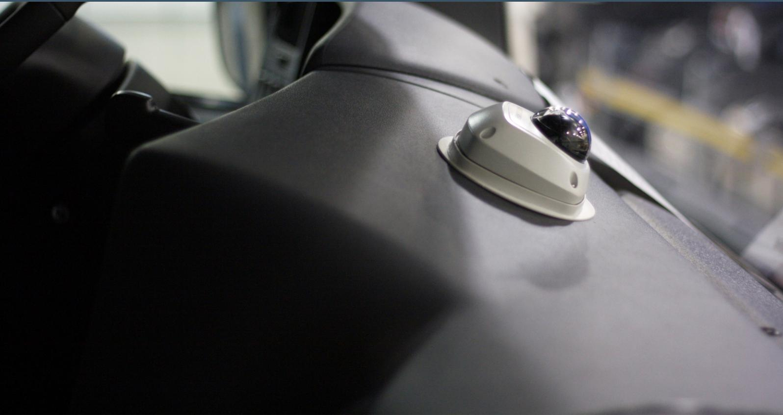
Кроме функции контроля за работой экипажа, передняя камера служит видеорегиистратором дорожной обстановки. Камера имеет антивандальное исполнение. Положение съёмки чётко фиксируется для того чтобы водитель не мог изменить угол обзора повернув камеру в сторону. Поддерживается запись звука.
